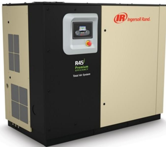
为了使空压机能够正常可靠地运行,保证机组的使用寿命,空压机定期维护、定期检查保养,才会有好的工作状态。正确的保养可以增加整个机器的使用寿命,减少了故障停机的时间,否则出主机积碳咬住等故障,造成更大的损失。•空压机多久保养一次螺杆空压机的保养周期各厂家给客户提供了参考时间,如果空压机安装在干净、温度较低的环境时,服务周期可以适当延长,应根据空压机使用环境来制订正确的服务周期。一般情况下,新机使用500小时后,需要更换机油格、螺杆机专属机油;而后每3000个小时,更换保养耗材:油气分离器、机油格、风格、机油。如果环境很脏,粉尘很多,则要适当缩短这个时间。另外要注意的是,夏天温度变化,空压机容易发生高温故障,也需要多注意勤保养。带PLC电脑操作屏的螺杆式空压机,会在显示屏上显示保养信息参数并提醒,到了保养时间,会自动报警。黄山无油机空压机价格静音空压机分为有油静音空压机和无油静音空压机。
